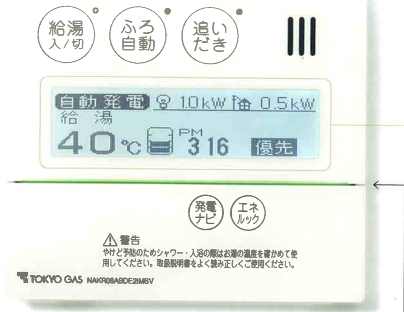
発電中にランプが点灯します。
